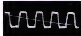
Bild 4. Die günstigste Kurvenform ergab sich mit einem Strom-Wendekondensator von 5 \text{ nF}
